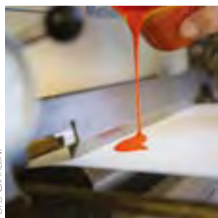
Una racla in metallo spalma un sottile strato di materiale polimerico su un supporto tessile
